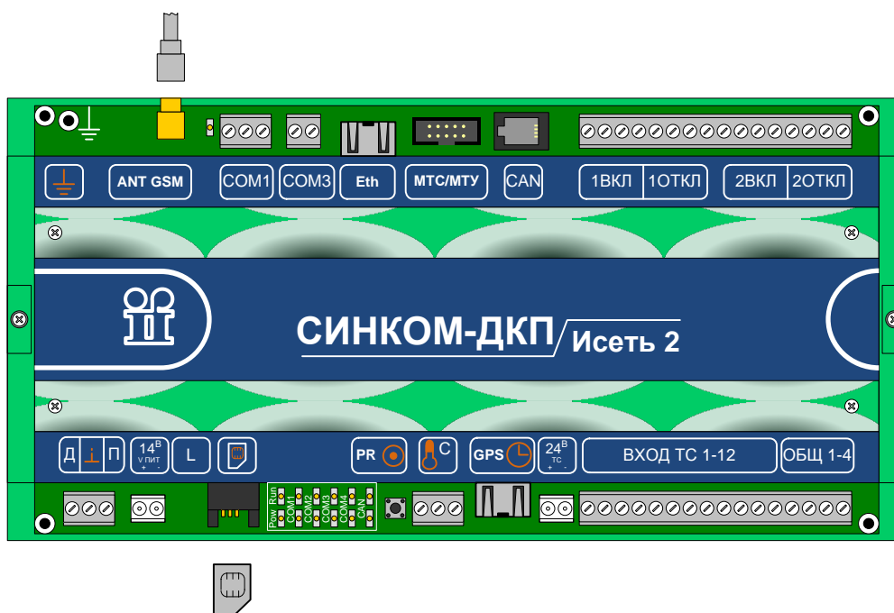
Рис. 7. Подключение SIM-карты и антенны GSM ANTEY 915 SMA к контроллеру «Синком-ДКП»
