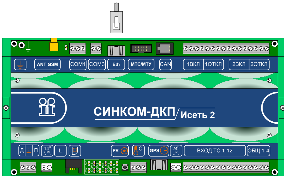
Рис. 5. Подключение канала Ethernet к контроллеру «Синком-ДКП»
